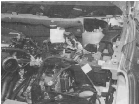
图 5-66 装发动机舱内制动、冷却、空调、助力转向等系统管路
