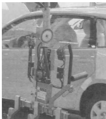
图 5-65 检查车门缝隙
