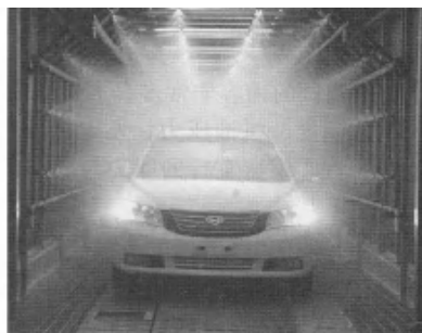
图 5-105 防雨密封性测试
