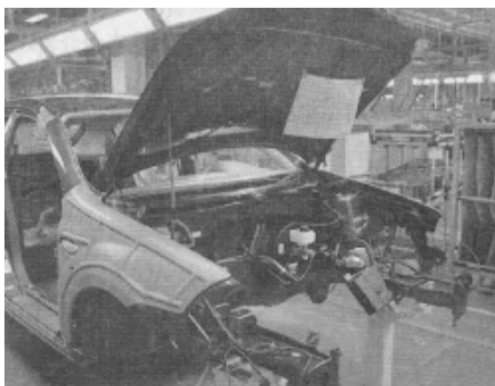
图 5-27 安装制动总泵、制动管路及 ABS 泵
