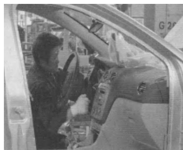
图 5-24 安装转向盘及组合开关
