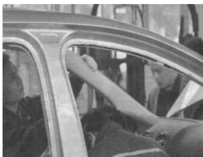
图 5-23 安装 A, B 柱内装饰板
