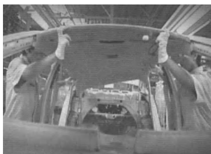
图 5-21 安装车顶内饰
