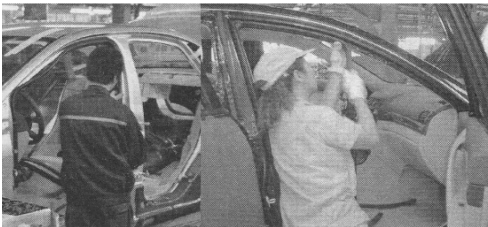
图 5-25 安装车门框密封条
