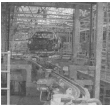
图 5-87 地面摩擦输送系统
