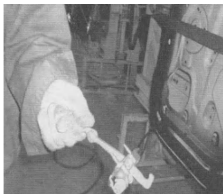
图 5-33 安装车门限位器、 专用车门装配架
