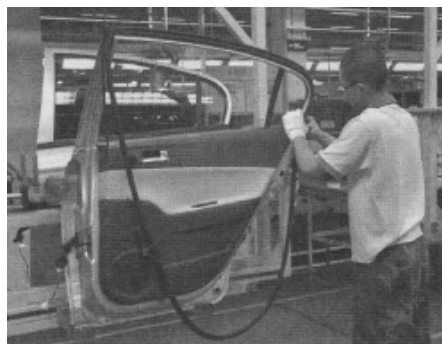
图 5-37 安装车门密封条
