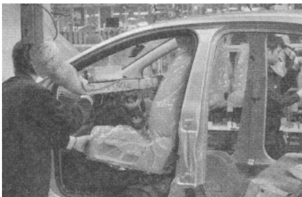
图 5-59 安装前排座椅
