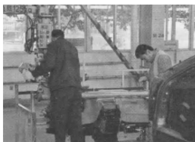
图 5-17 安装仪表台专用吊具
