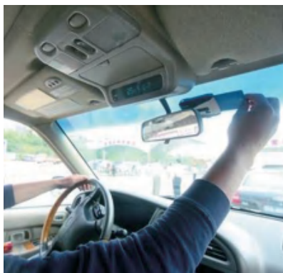
图 3-9 安装电子缴费卡 读写设备的车辆
