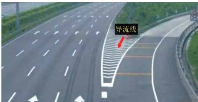
图 3-18 高速公路的导流线
