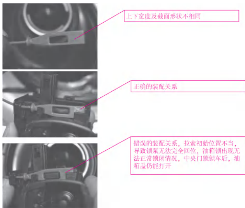
图 4-7-12 邮箱盖应急拉锁装配图
