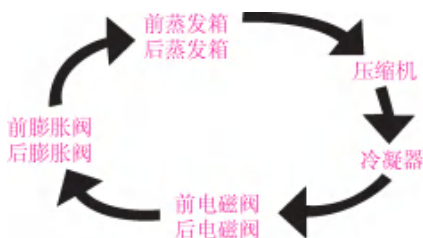
图 4-7-1 宝马 745Li 制冷剂流向图
