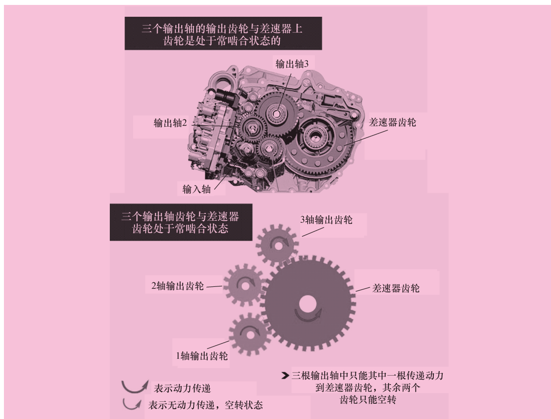
图13-3 双离合变速器齿轮常啮合结构简图
