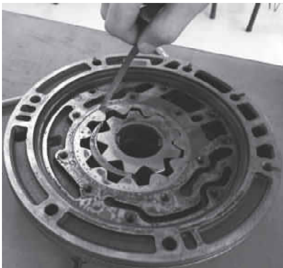
图 3-15 检查泵体间隙
